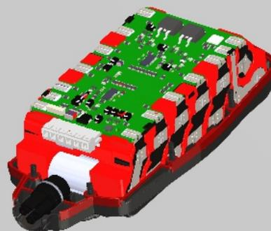
Батарея оснащена электронной системой управления и защиты аккумуляторов (BMS)
